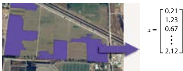
Figura 5 Extracción de un vector de rasgos sobre una región de la imagen definida por un polígono
